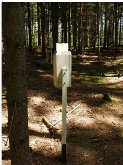
Obr. 15 Odběr typu „throughfall“, povodí lesního potoka observatoře Košetice (foto: J. Svobodová)
