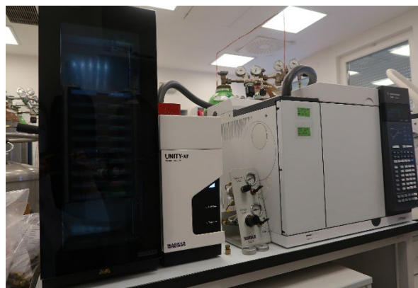
Obr. 10 Plynový chromatograf pro stanovení benzenu ze sorpčních trubiček (foto: CLI Praha Libuš)
