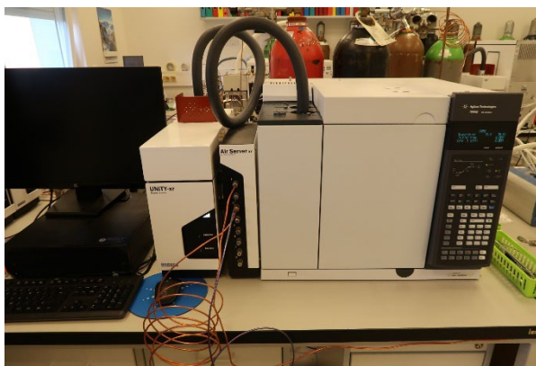
Obr. 9 Analyzátor GCMS pro stanovení těkavých organických látek (VOC) odebíraných do kanystrů (foto: CLI Praha Libuš)
