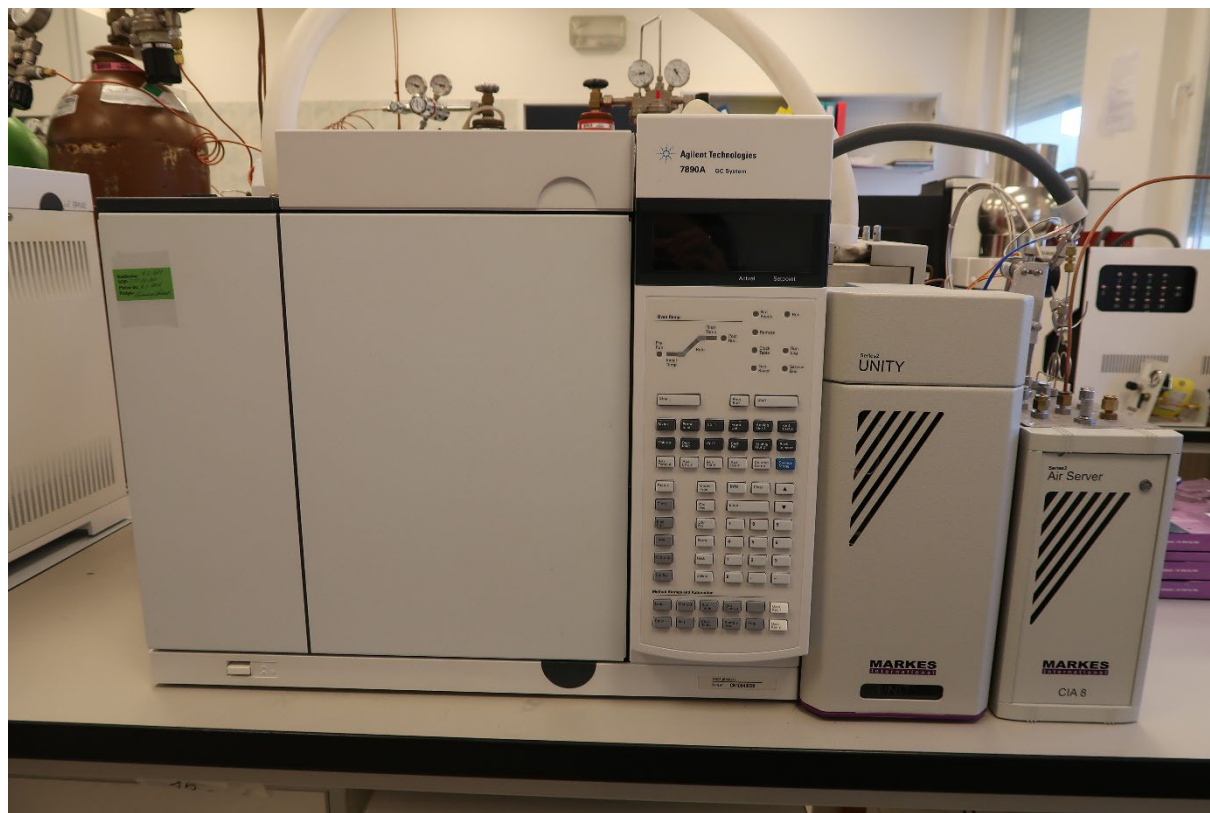
Obr. 7 Plynový chromatograf s FID detektorem pro stanovení těkavých organických látek (VOC) ve venkovním ovzduší (foto: CLI Praha Libuš)
