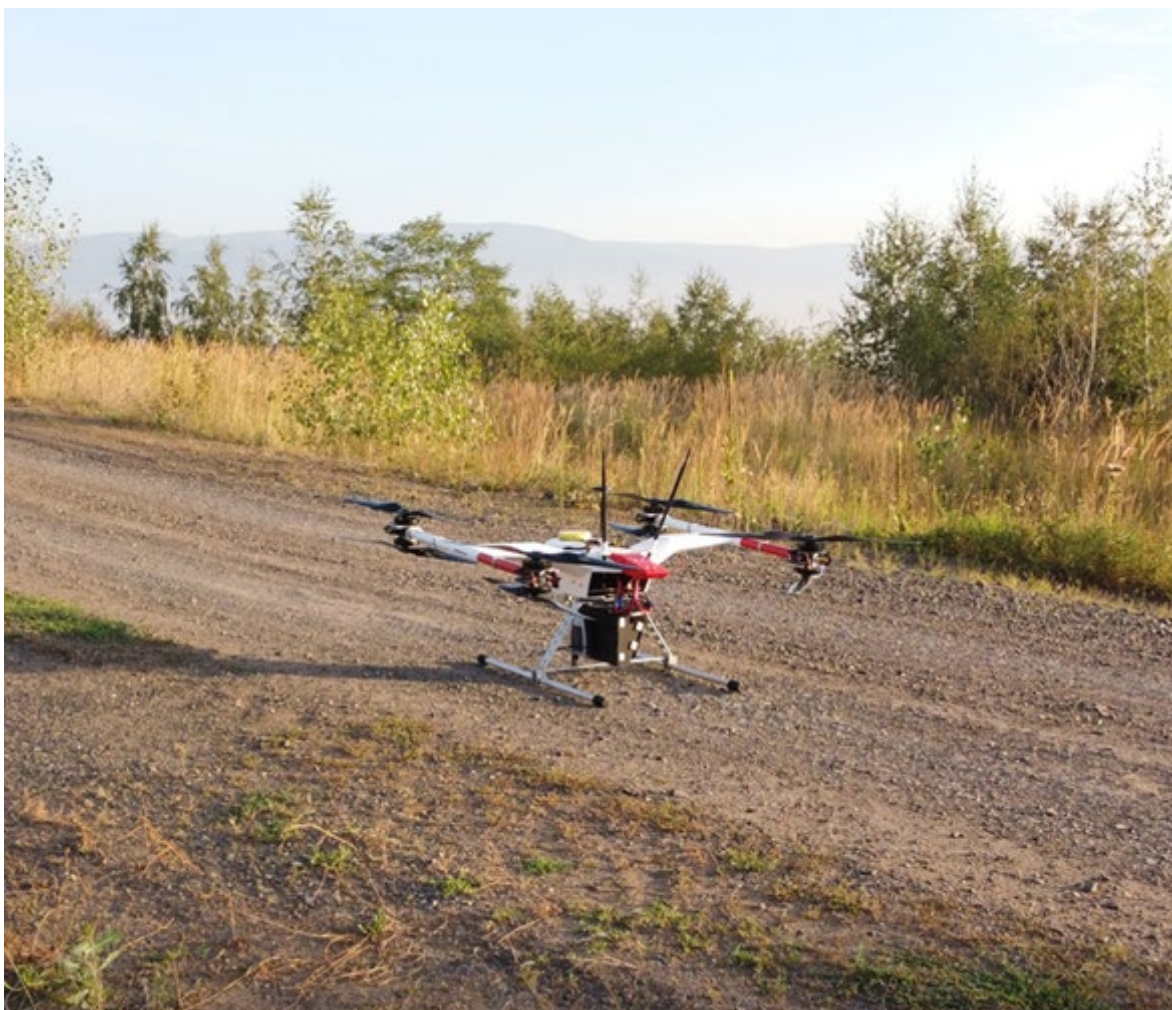
Obr. 8 Dron sloužící jako nosič přístrojů pro měření kvality ovzduší (foto: Observatoř Tušimice)
